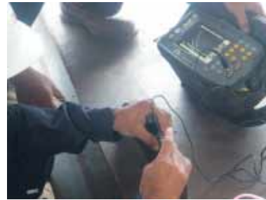
導水鋼管への超音波探傷試験風景
