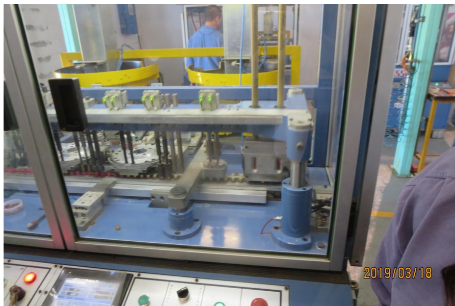
自社製造のプラスチック薬莖への火薬&散弾の装填機
