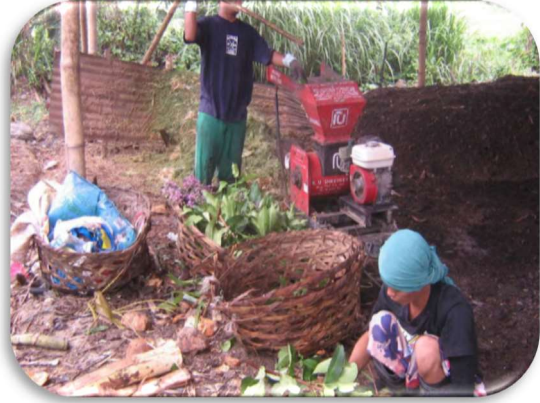
写真 5-84 大きな生ごみの破碎
