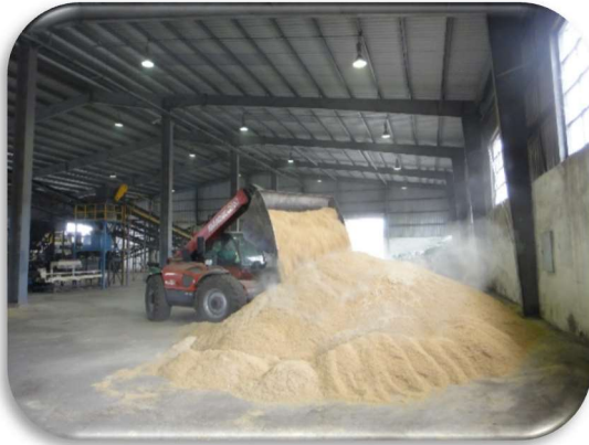
写真 5-23 床材のもみ殻と米ぬかの混合量が多いのでホイールローダー使用
