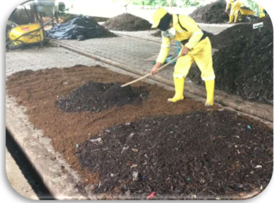
写真 5-105 発酵床(リターンコンポスト)を敷く
