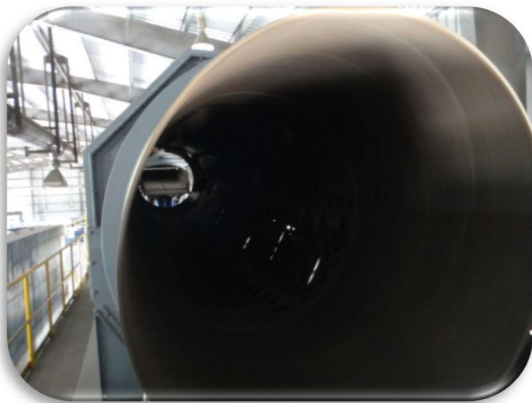
写真 5-142 トロンメル篩による異物の除去
