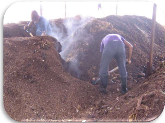
写真 5-88 発酵床を移動させながら攪拌
