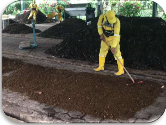
写真 5-104 おが屑を水分吸収材として敷く
