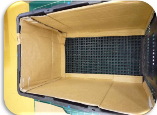
写真 5-32 容器とダンボールを合わせ、ふちには重なりシロがある
