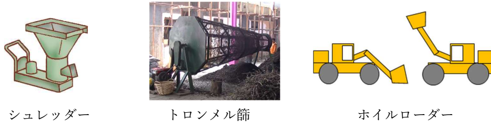
図 5-16 コンポストセンターで使用する機械類(例)
